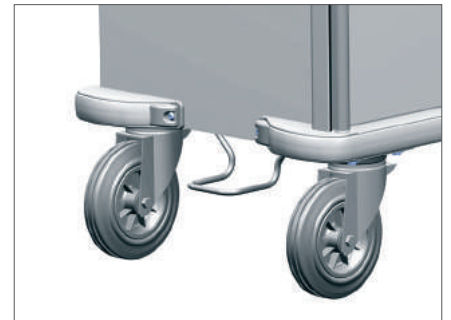
Sonderrollen Edelstahlrollen mit Richtungsfeststeller, Zentralstopp und Totalfeststeller, für unterschiedliche Anwendungen.
