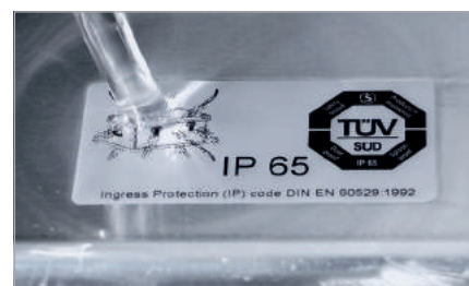
Strahlwasserschutz nach Norm IP 65
